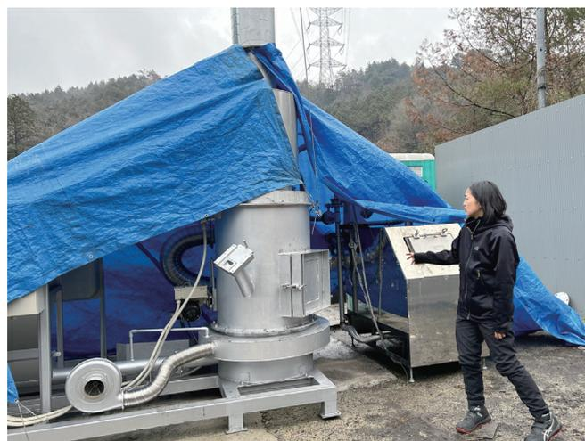
写真4：ハワイへの出荷を待つペットボトル炭化装置
